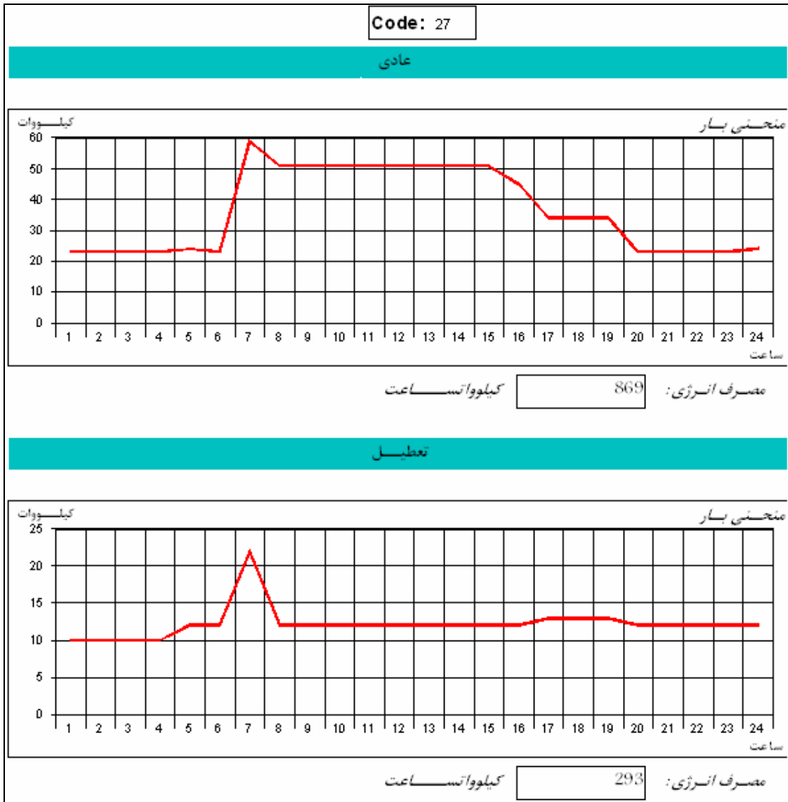
شکل (۱-۱۶) منحنی بار روشنایی سرانه مراکز تولید فلزات اساسی (کد ۲۷) طی ساعات مختلف از روزهای عادی
