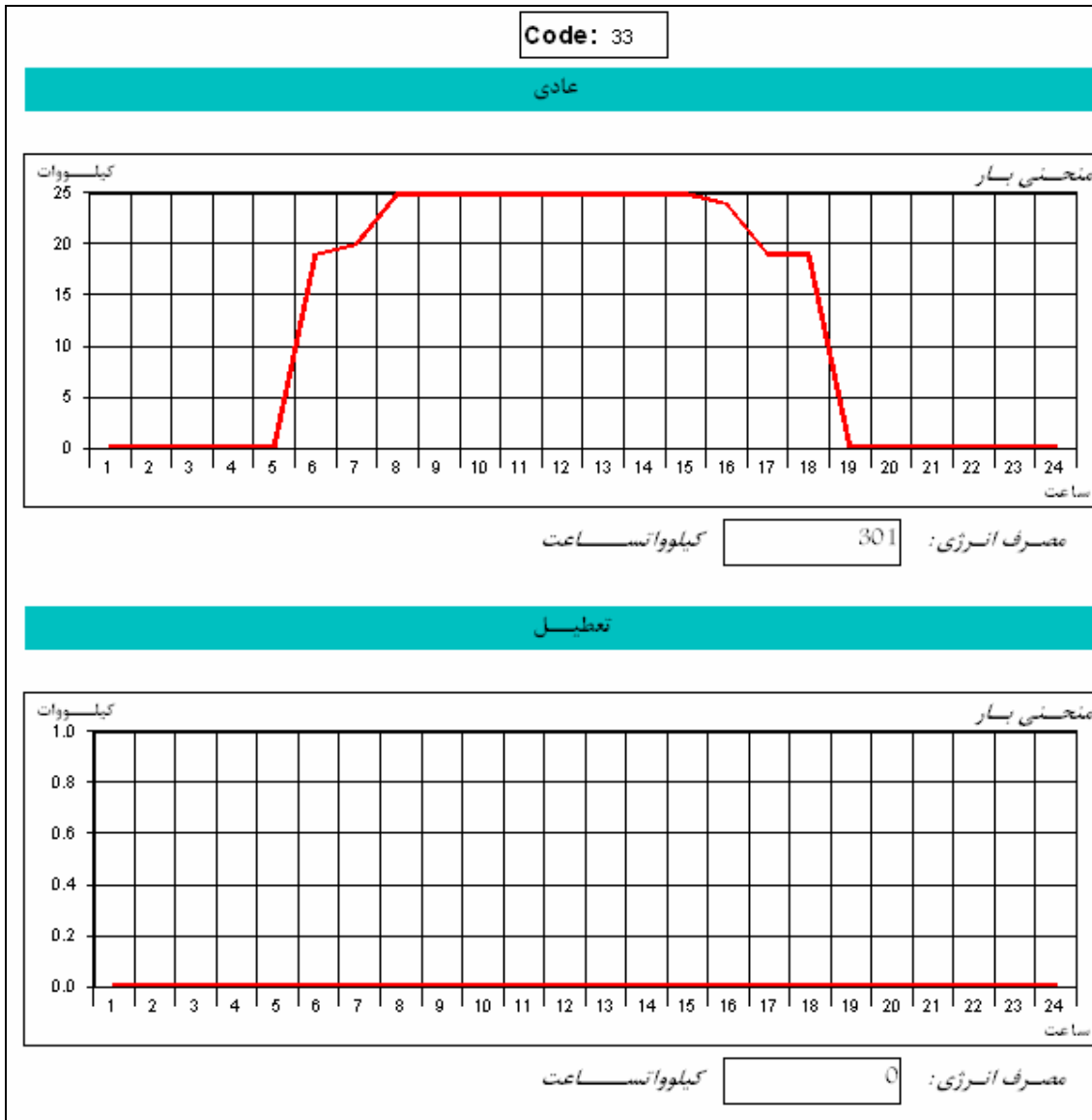
شکل (۱-۲۲) منحنی بار روشنایی سرانه مراکز تولید ابزار پزشکی (کد ۳۳) طی ساعات مختلف از روزهای عادی و
